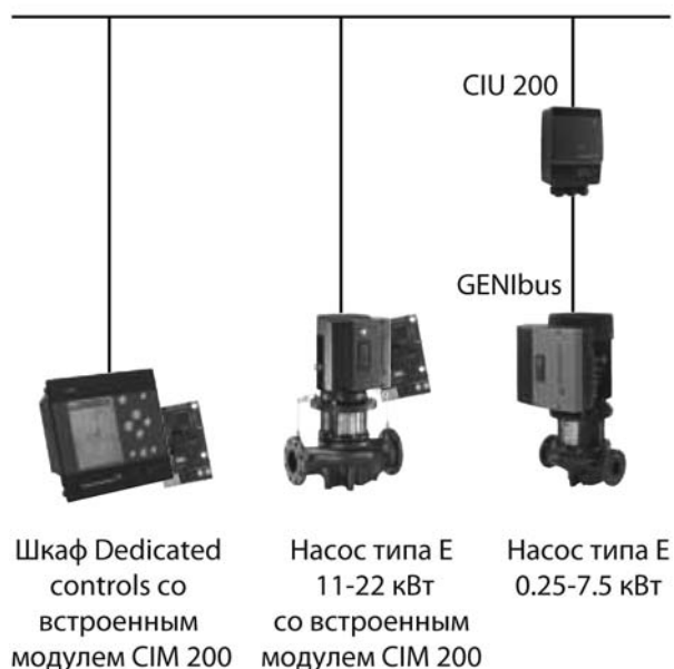
Modbus RTU сеть
