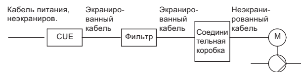
Рис. 43 CUE и фильтр установлены на расстоянии от скважины
