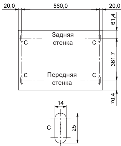
Рис. 56 Шаблон для сверления под подставку (мм)
